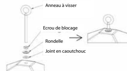
Les appareils sont fournis avec un anneau à visser qui permet la suspension avec une chaîne (anneau fourni non visé). S'assurer que l'anneau soit correctement visé à l'appareil et que le joint en caoutchouc soit bien en place pour empêcher la pénétration d'eau, comme illustré ci-dessous.
