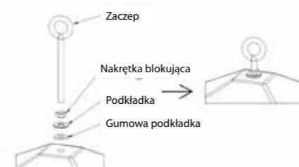
poawieszenie urządzenia za pomocą lańcucha (w komplecie). Należy upewnić się, że zaczep jest odpowiednio zabezpieczony a gumowa podkładka chroniąca przed przedostaniem się wody jest założona zgodnie z rysunkiem poniżej.
