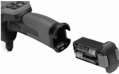
Figura 4 – Compartimiento de las pilas
