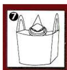
5. Colocar nuevamente la torrecilla sujetando las orejillas de la misma dentro de los agujeros en el plato cubridor.
