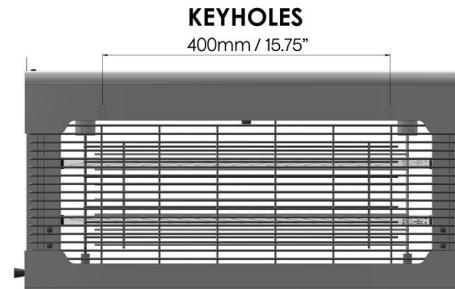
Wywiercić 6mm otwory o długości 35mm. Umieścić kołki i śruby (załączone) w otworach, pozostawiając na zewnątrz końcówki śrub na 5mm. Zawiesić lampa (otwory z tyłu lampy na obudowie w kształcie dziurki od klucza) na śrubach i upewnić się, że wisí w sposób bezpieczny.
