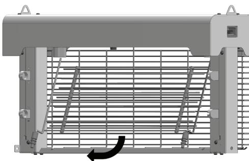
Zet het toestel terug in mekaar in de omgekeerde volgorde en zorg ervoor dat het rooster in de verende connectoren wordt geplaatst.
