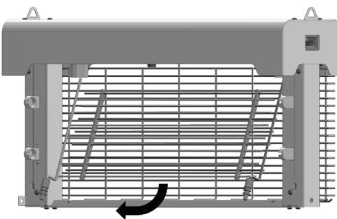
Złożyć lampę z powrotem wykonując powyższe czynności w odwrotnej kolejności. Upewnić się, że ruszt elektryczny został prawidłowo włożony.
