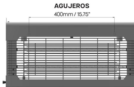
Se suministran 2 tacos de plástico y 2 tornillos. Taladre orificios de 6 mm a una profundidad de 35 mm. Inserte los tacos y los tornillos en los orificios hasta que sobresalgan 5 mm. A continuación, cuelgue el aparato de los dos tornillos. Asegúrese de que está bien sujetado.
