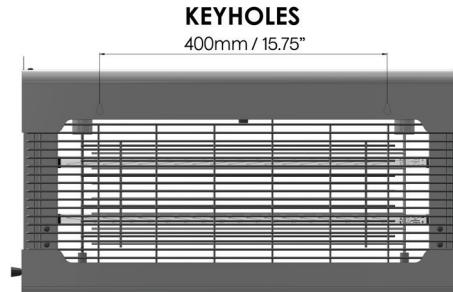
Utilizzando i 2 tasselli e le viti in plastica forniti, l'unità si aggancia semplicemente alle 2 viti tramite le asole sul retro dell'unità. Praticare fori da 6 mm a una profondità di 35 mm. Con i tasselli di plastica forniti, inserire le viti nei fori lasciando sporgere 5 mm. Quindi, appendere l'unità sulle 2 viti sporgenti assicurandosi che sia ben fissata.
