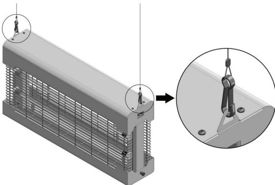
**Let op:** Controleer voordat u het toestel installeert of het oppervlak waaraan het moet worden opgehangen het gewicht kan dragen.
