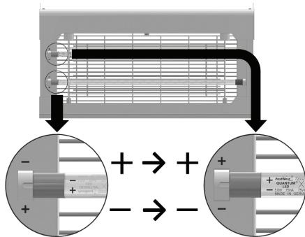
La sostituzione delle lampade LED avviene seguendo la procedura inversa rispetto alla rimozione.
