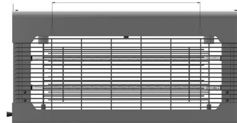
utskjutande. Häng sedan upp enheten på de två utskjutande skruvorna. Se till att den är säkert monterad. Se till att väggen är lämplig för den typ av beslag som levereras. Om enheten monteras på gipsskivor eller liknande väggar skall lämpliga fästen användas.
