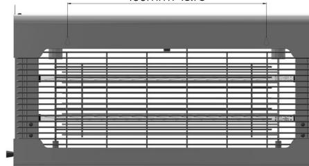
L'appareil s'accroche simplement sur les deux vis fournies par le biais des orifices de fixation situés à l'arrière de l'appareil. Employer une mèche de 6 mm pour percer à une profondeur de 35 mm. Utiliser les vis et chevilles fournies, laisser un espace de 5 mm entre le mur et la tête de la vis. Accrocher l'appareil sur les deux vis en veillant à ce qu'il soit sécurisé.
