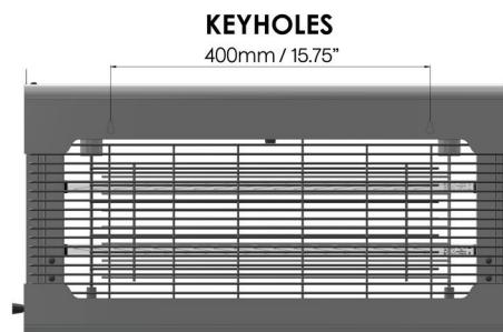
Das Gerät einfach durch die Schlüssellochbohrungen auf der Rückseite des Gerätes an den 2 Schrauben einhängen. 6 mm Löcher mit einer Tiefe von 35 mm bohren. Stecken Sie die Schrauben mit den mitgelieferten Kunststoffdübeln 5 mm vorstehend in die Löcher. Dann das Gerät an den 2 hervorstehenden Schrauben einhängen und auf festen Sitz prüfen.
