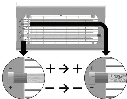
Der Austausch der LED-Röhren erfolgt in umgekehrter Reihenfolge.
