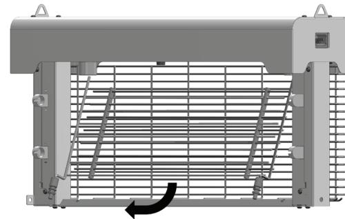
Bauen Sie das Gerät in umgekehrter Reihenfolge wieder zusammen und achten Sie darauf, dass das Gitter wieder in die federbelasteten Verbindungen eingesetzt wird.
