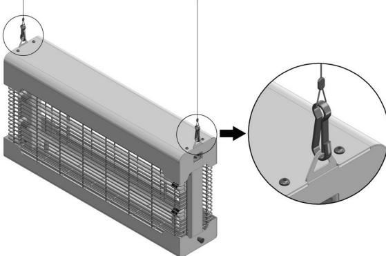
**Varning:** Innan installation, se till så att monteringsytan (tak eller vägg) är kapabel att stödja vikten.
