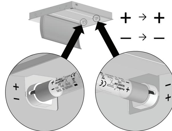
Das Einsetzen neuer LED-Röhren ist das gegenteilige Verfahren des Entfernens. Schließen Sie die Frontabdeckung und schalten das Gerät wieder ein.
