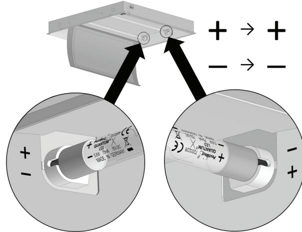
Het vervangen van de LED-lampen is de tegenovergestelde procedure van verwijderen. Sluit de voorklep door deze weer omhoog te klappen en schakel het toestel weer in.
