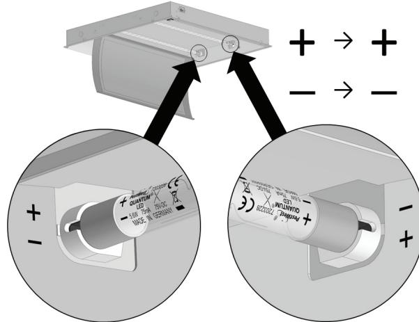
Installer les nouveaux tubes LED en suivant la procédure inverse de celle décrite pour leur retrait. Refermer le réceptacle sur les deux ergots de maintien puis mettre en marche l'appareil.
