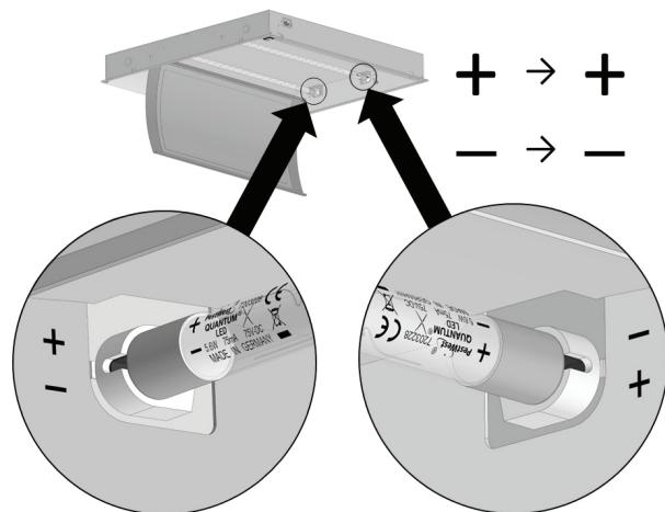
Wymiana nowych światłowek LED odbywa się poprzez odwrócenie procedury wyjmowania zużytych światłowek. Podnieść i zamknąć panel przedni, następnie włączyć lampa owadobójczą.
