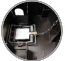
Die Fenn MK4-Fallen können mit Hilfe der Kette am Boden oder einer Köderstange gesichert werden.
